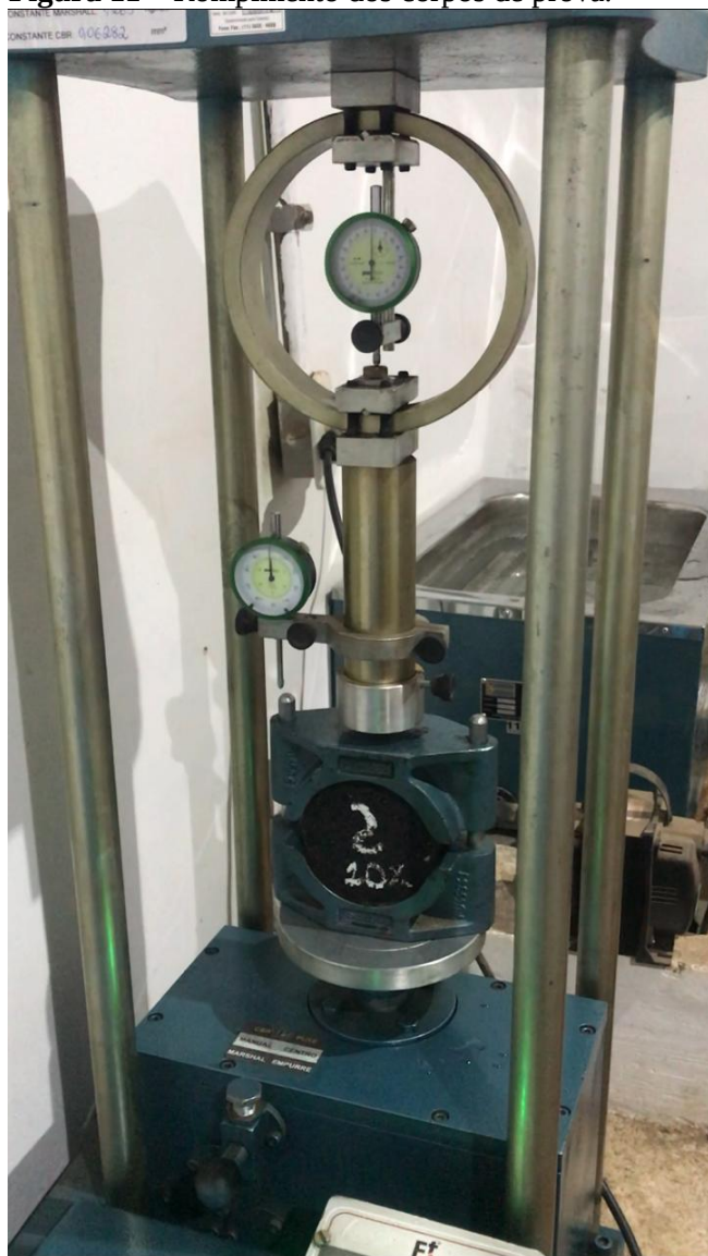
Figura 11 – Rompimento dos corpos de prova.
