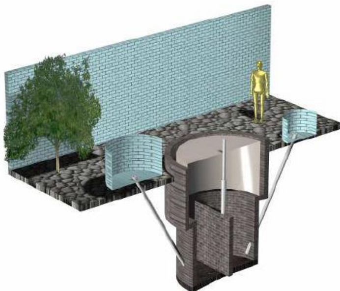
Figura 2.4: Vista tridimensional, em corte, do biodigestor modelo indiano.
