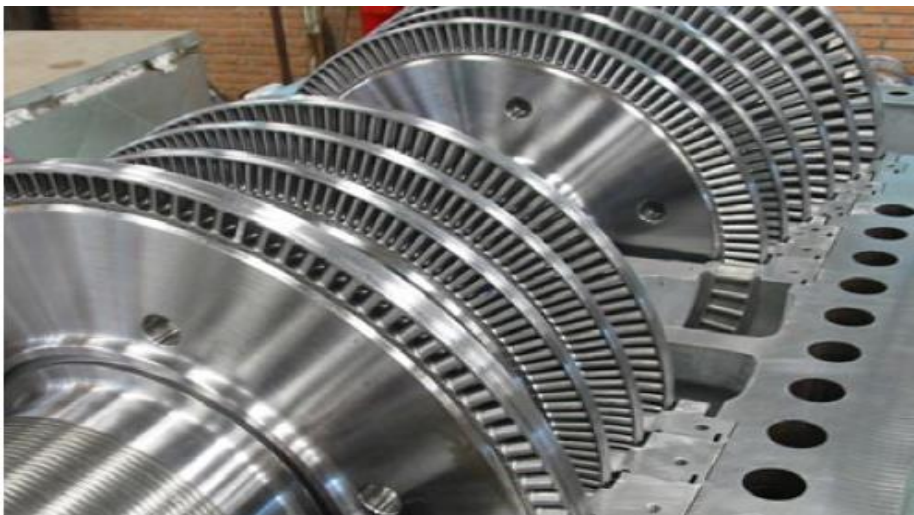
Figura 11: Turbina de Contrapressão com Múltiplos Estágios
