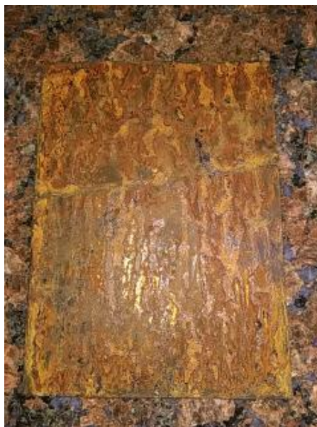
Figura 9: Amostra do aço 1045 após ensaio de corrosão
