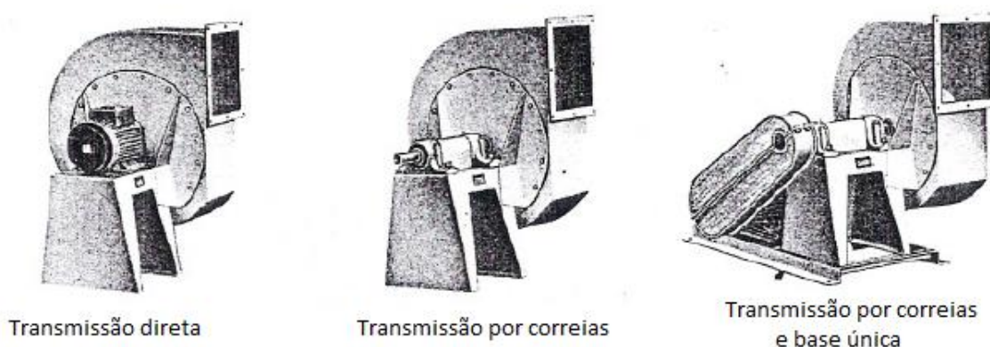
Figura 17 – Variante de acionamento dos ventiladores
