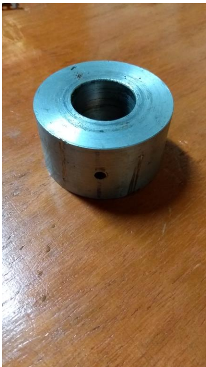
Figura 21 - Bucha com o furo para a entrada de lubrificante
