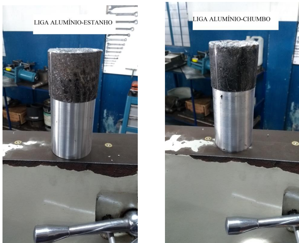
Figura 9 - Processo de usinagem dos tarugos das ligas de alumínio
