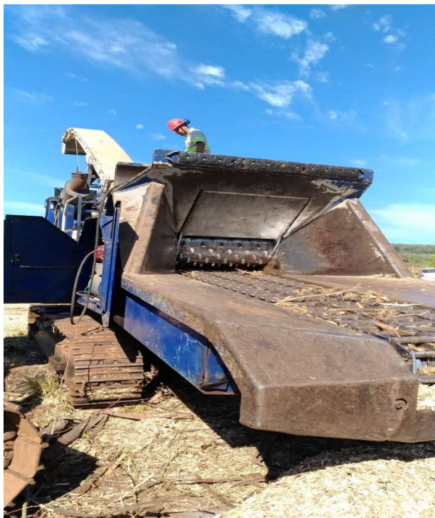
Figura 5 – Entrada de lenha no picador
