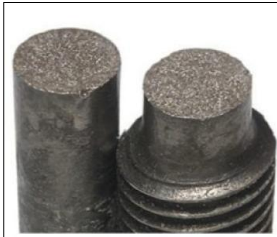
Figura 10: Fratura Frágil. Fonte: CALLISTER (2012).
