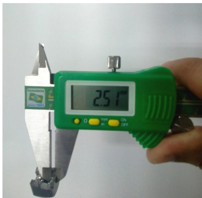
Figura 14: Espessura da parede do canal da esfera.
