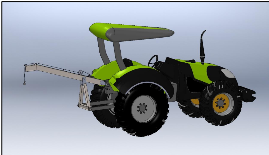
Figura 25 – Trator com guincho traseiro com sistema de içamento
