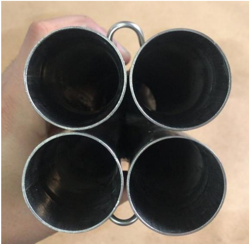
Figura 09: Junção do tubo primário com o secundário vista frontal.
