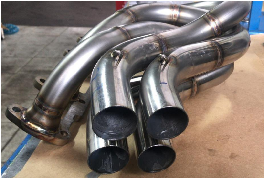
Figura 07: Tubo primário do coletor de escape vista lateral.
