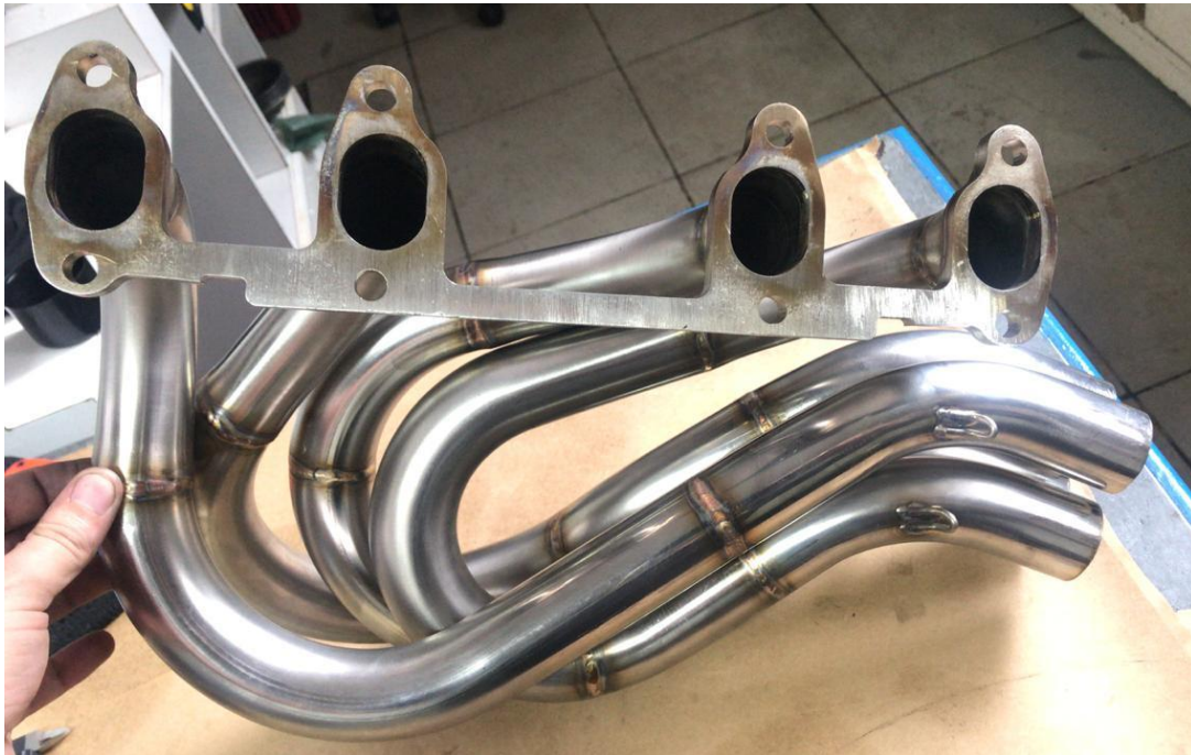
Figura 06: Tubo primário do coletor de escape vista frontal.
