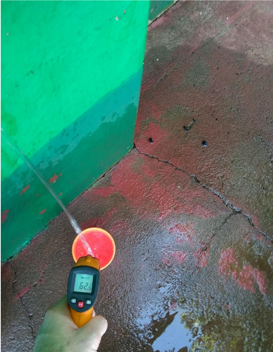
Figura 15: Temperatura máxima de saída da água quente durante o teste, vazão de 44,2l/h
