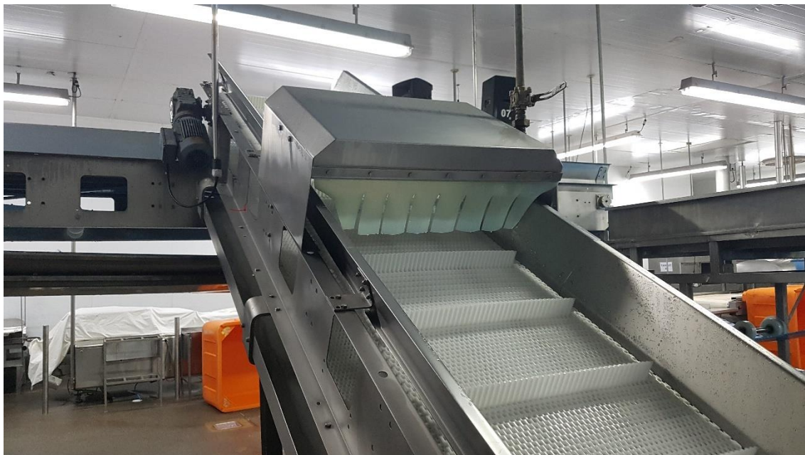
Figura 11 – Esteira com sistema de umidificação.
