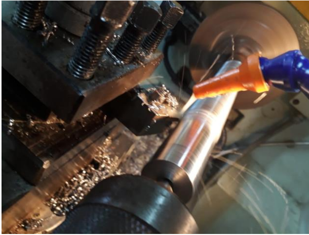
Figura 23 - Processo de usinagem com mangueira de refrigeração
