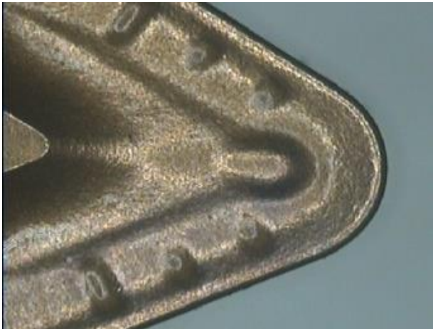
Figura 20 – Pastilha TAEGUTEC antes da usinagem da primeira experiência
