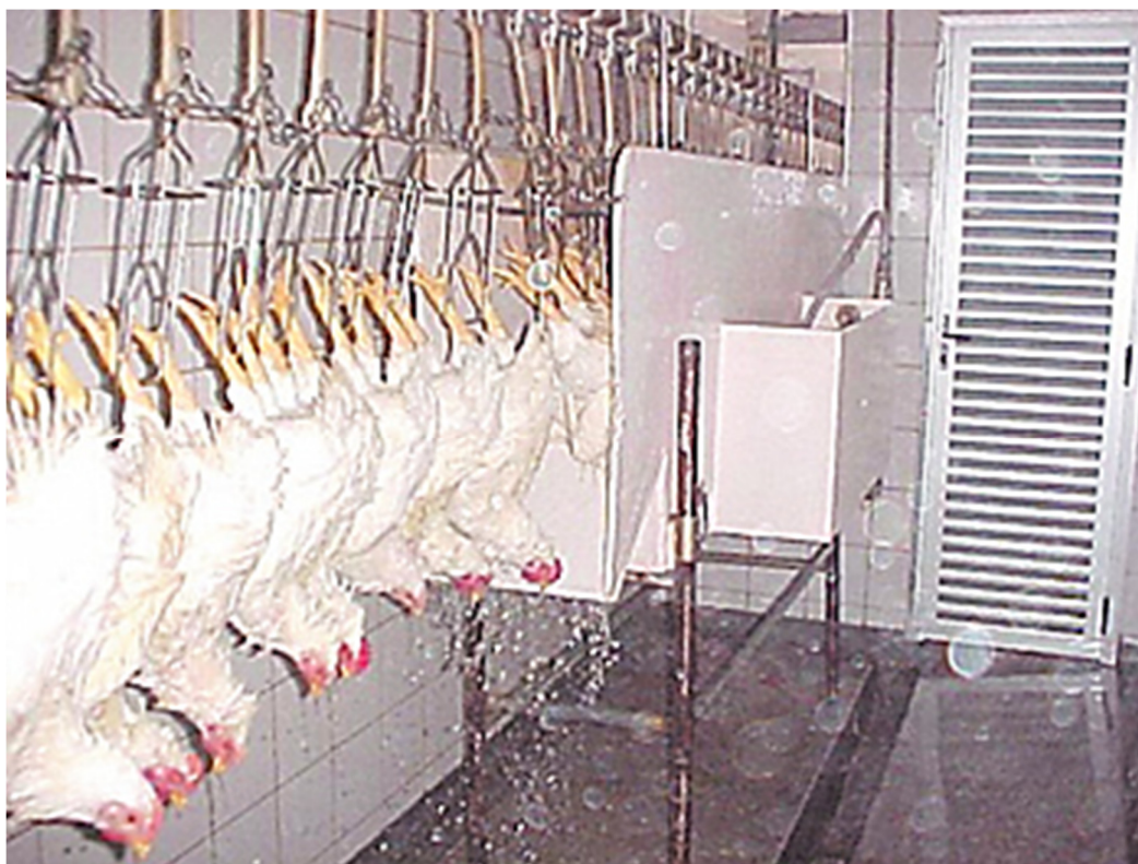
Figura 3 - Insensibilização por eletronarcose.
