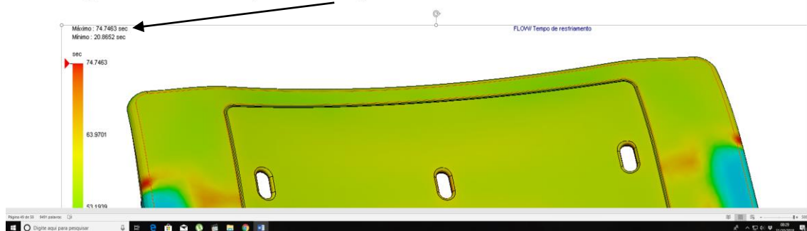
Figura 22– Simulação do tempo de resfriamento da cadeira.
