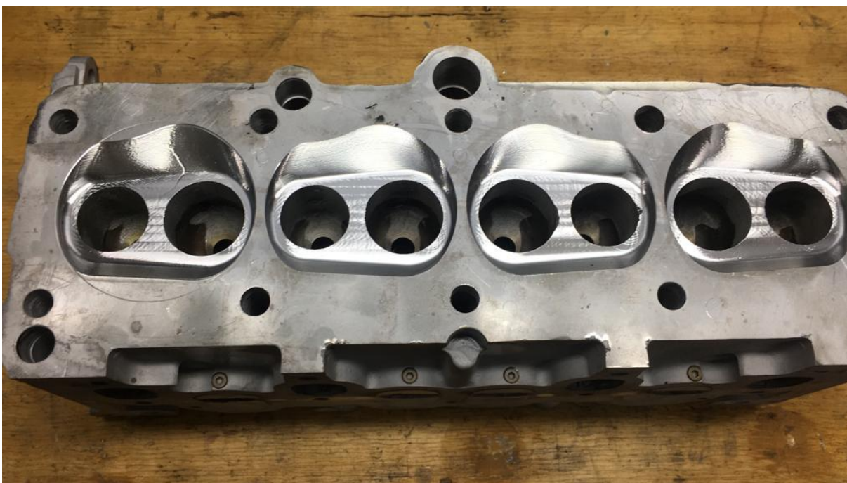
Imagem 24: Cabeçote usinado com modelo de câmara priorizando o swirl.
