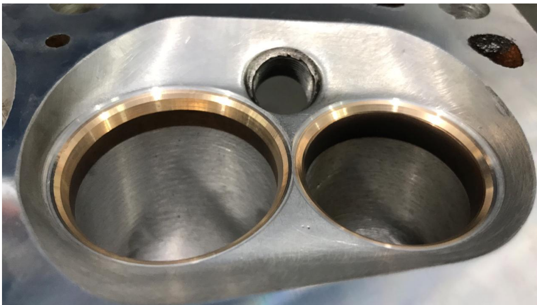
Imagem 01: Retrabalho de angulações em sedes de válvulas.
