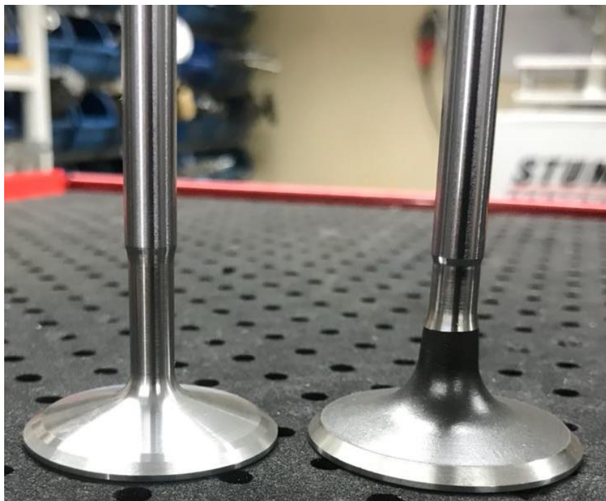
Imagem 02: Válvula retrabalhada e válvula original.
