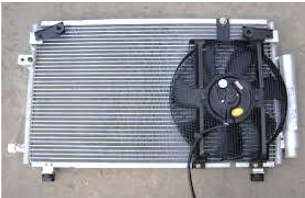
Figura 4 - Condensador Refrigerado a Ar.
