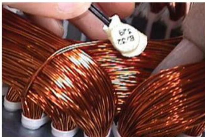
Figura 3: Instalação do termostato
