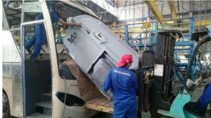
Figura 4: Içamento do sanitário
