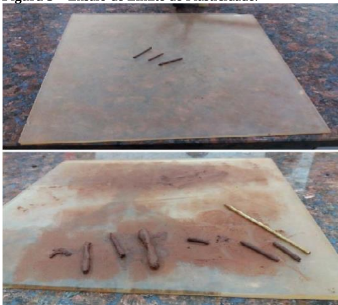
Figura 3 – Ensaio de Limite de Plasticidade.
