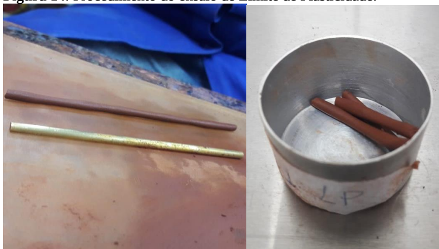
Figura 14: Procedimento do ensaio de Limite de Plasticidade.
