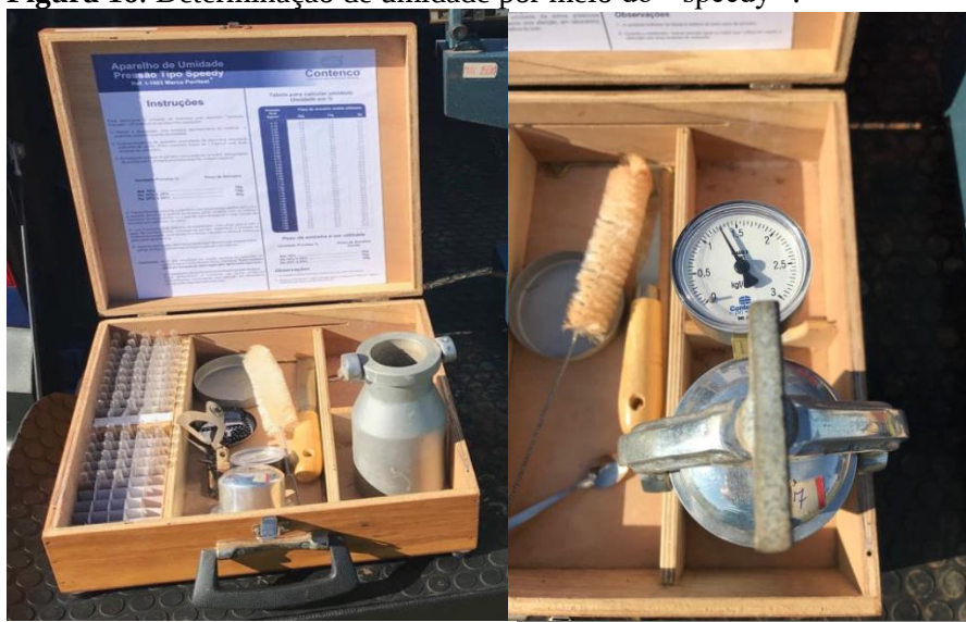
Figura 16: Determinação de umidade por meio do “speedy”.
