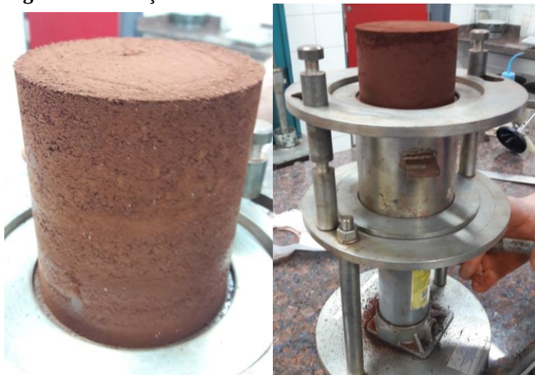
Figura 15: Extração de amostra do ensaio de Proctor.
