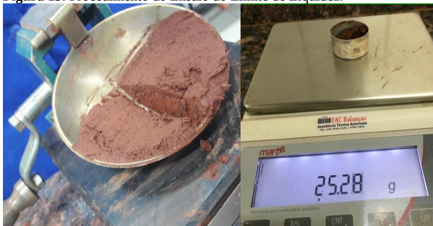
Figura 13: Procedimento do Ensaio do Limite de Liquidez.
