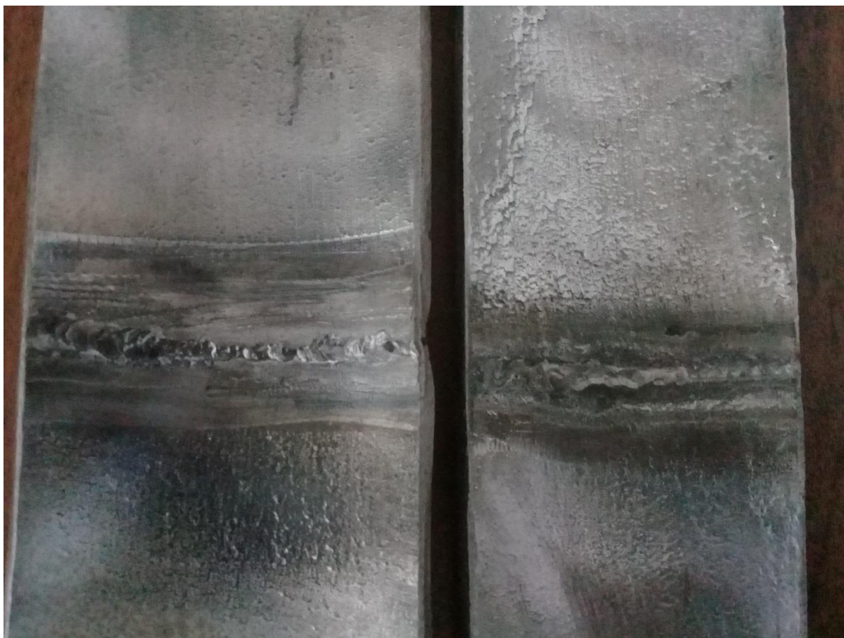
Figura 9 – Penetração da solda das peças 2 e 3 do grupo 1
