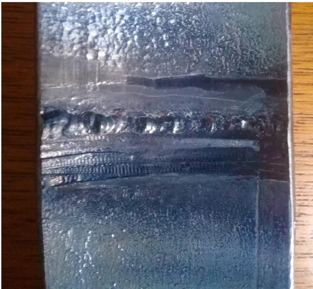
Figura 10 – Penetração da solda da peça 1 do grupo 2
