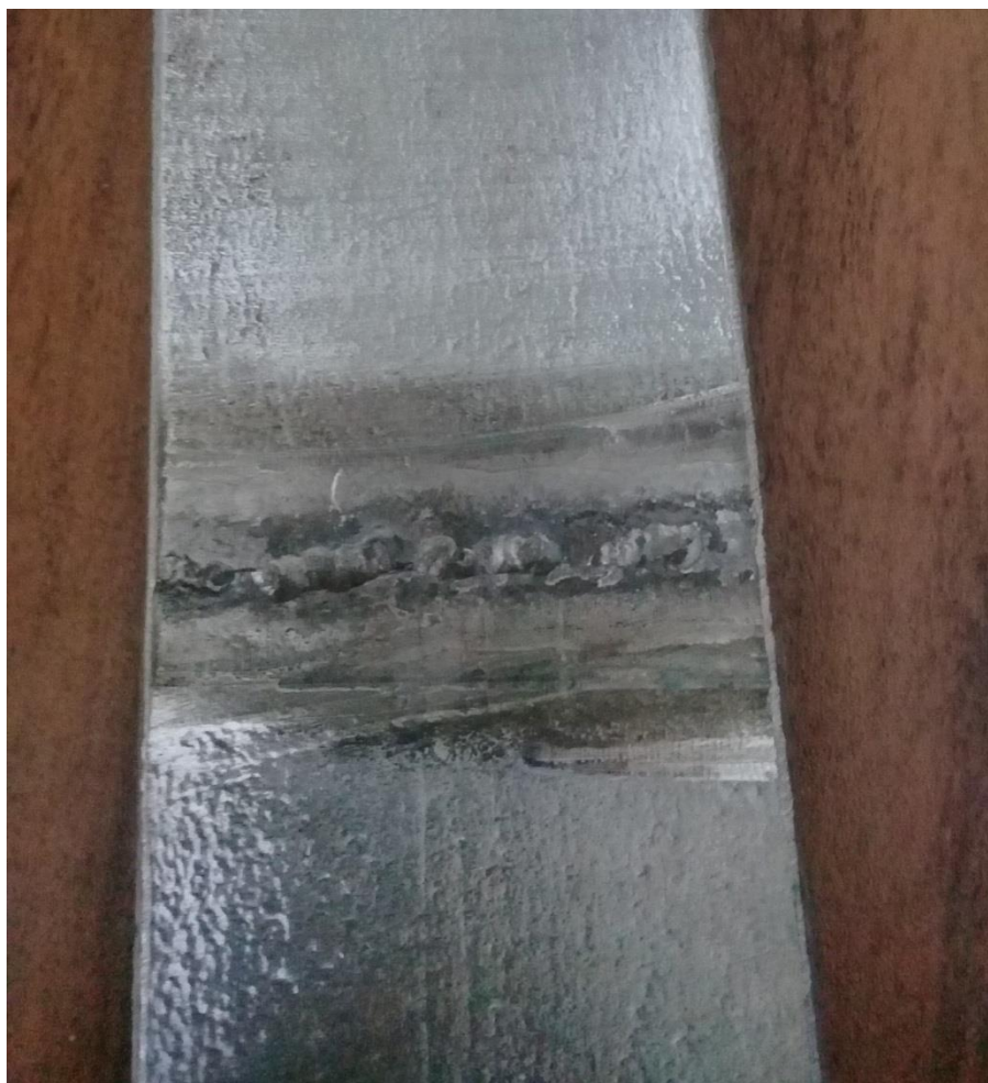
Figura 8 – Penetração da solda peça 1 do grupo 1
