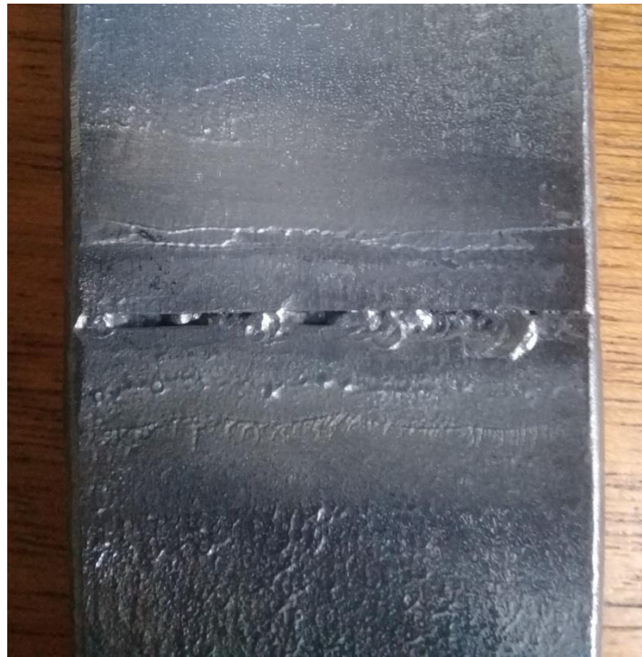
Figura 11 – Falta de penetração da solda da peça 2 do grupo 2
