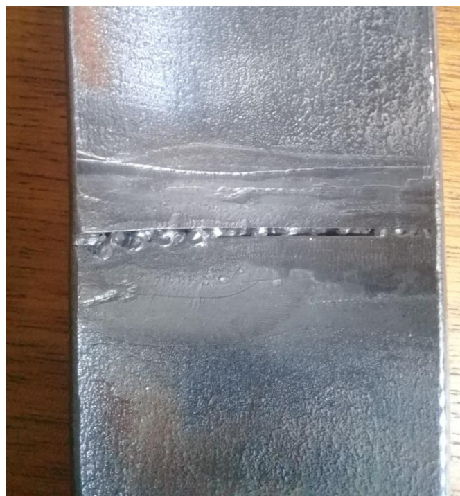
Figura 12 – Falta de penetração da solda da peça 3 do grupo 2
