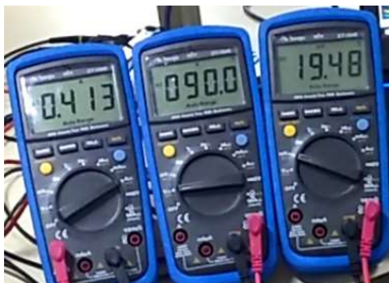
Figura 4.11: Corrente em CA(A), tensão em CA(V) e tensão em CC(mV) respectivamente, com PWM
