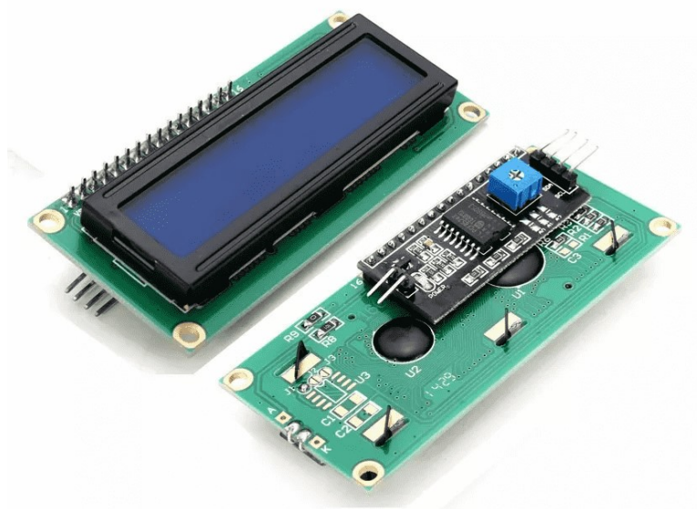
Figura 3.8: LCD 16x2 com módulo de comunicação serial I 2 C incorporado
