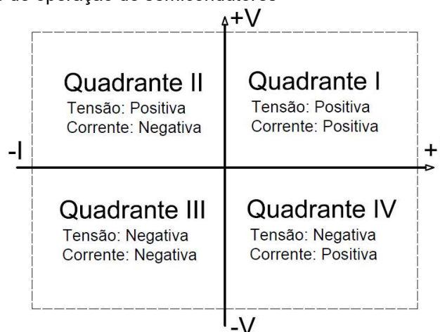
Figura 2.24: Quadrantes de operação de semicondutores
