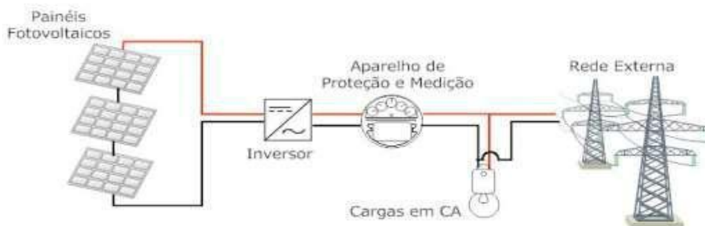
Figura 2.5 – Sistema fotovoltaico conectado à rede.
