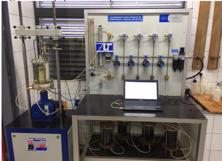
Figura 32: Equipamento de prensa triaxial durante realização do ensaio.
