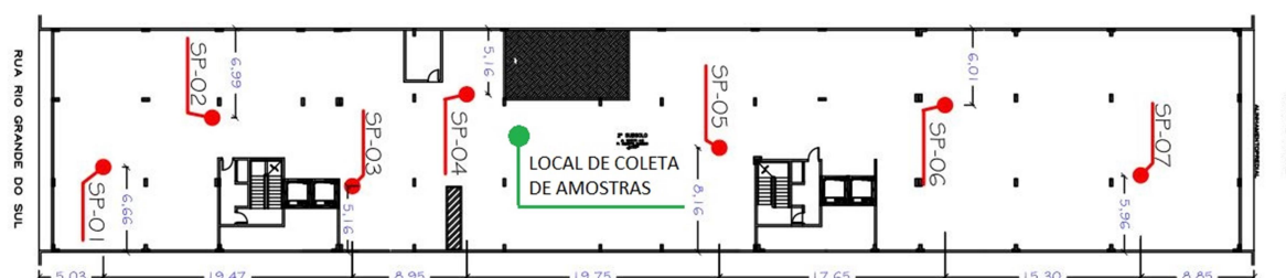
Figura 26 – Localização dos furos de sondagem à percussão na edificação e local de coleta de amostras.
