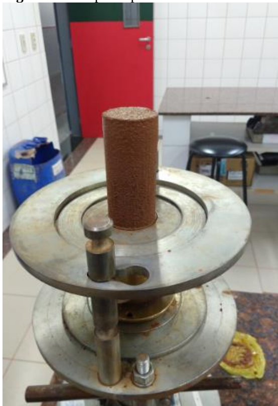
Figura 22: Corpo de prova moldado com material reciclado.
