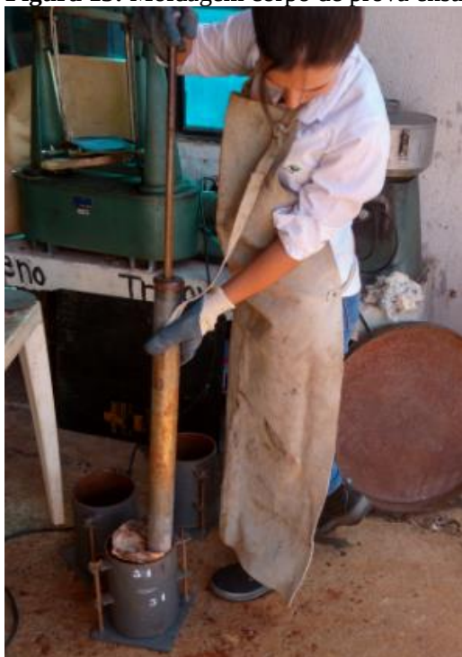
Figura 15: Moldagem corpo de prova ensaio compactação.
