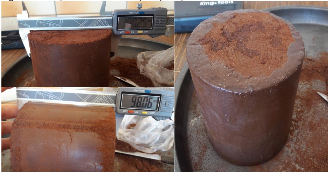
Figura 18: Aferição das dimensões e corpo de prova parafinado.
