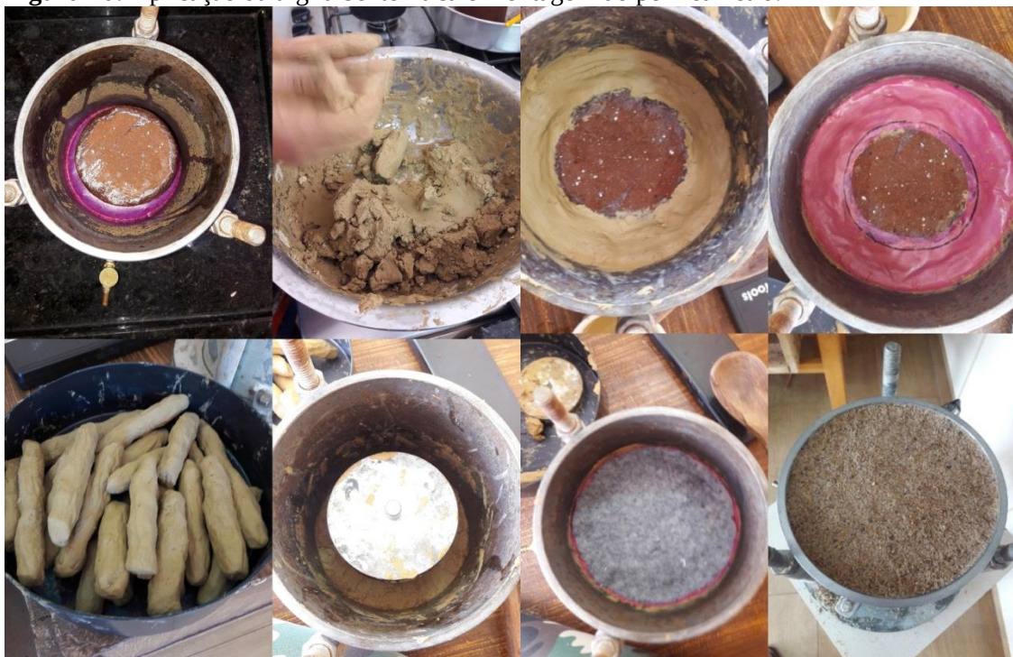
Figura 20: Aplicação da argila bentonítica e montagem do permeâmetro.
