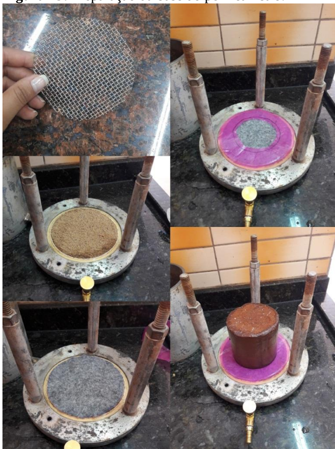
Figura 19: Preparação da base do permeâmetro.
