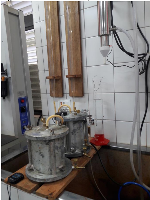
Figura 21: Permeâmetro acoplado ao sistema de aplicação e medição das cargas hidráulicas.
