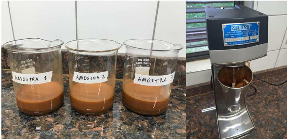
Figura 32: Amostra submersa em defloculante e aparelho dispersor.
