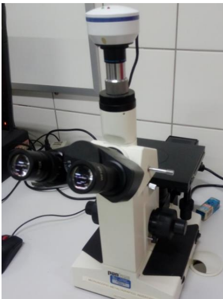
Figura 12: Microscópio invertido PanTec utilizado no ensaio metalografico.
