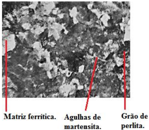
Figura 16: Metalografia Tempera em óleo.
