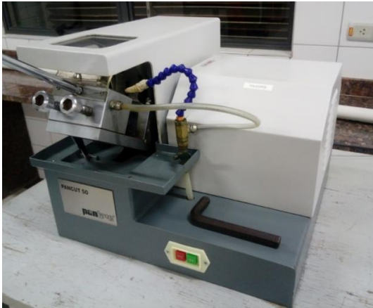
Figura 8: Policorte Pantec utilizado para corte dos corpos de prova.
