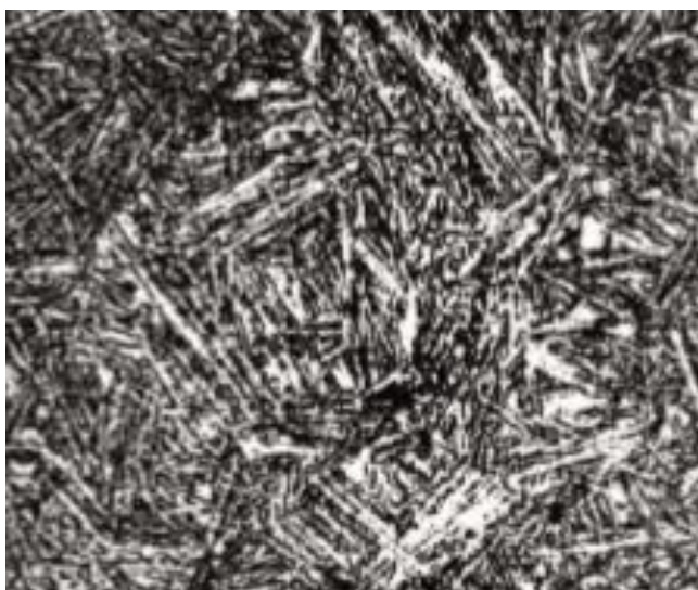
Figura 3: Martensita, com agulhas sobre um fundo de austenita retida.
