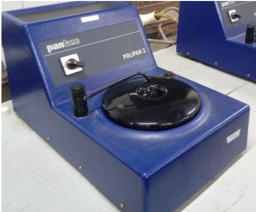
Figura 11: Lixadeira politriz utilizada para preparar os corpos de prova.
