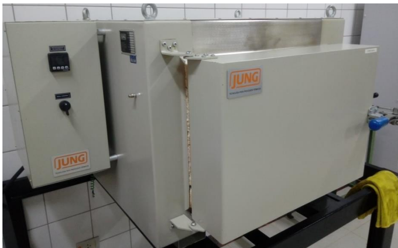
Figura 10: Forno JUNG utilizado nos tratamentos térmicos.
