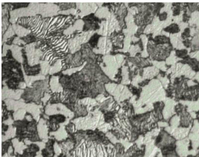
Figura 2: Aço com 0,35% de carbono resfriado lentamente contendo textura granular.
