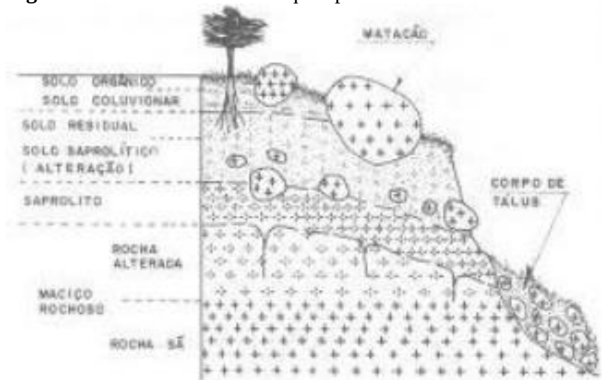
Figura 09: Perfil de um talude que apresenta solo residual e solo coluvionar.
