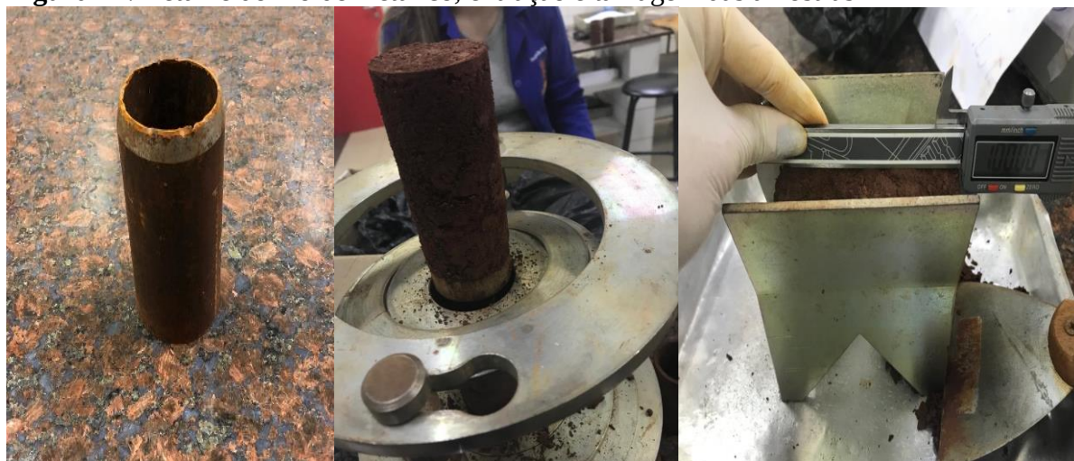
Figura 21: Detalhe do molde metalico, extração e talhagem das amostras
