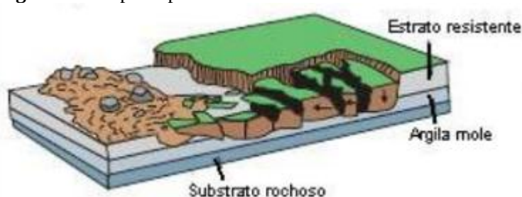
Figura 13: Ruptura por escoamento.
