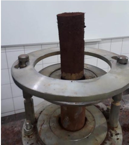
Figura 20 – Remoção das amostras com o extrator de amostras.
