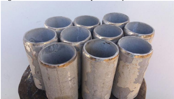
Figura 18 – Molde utilizado para extração da amostra.
