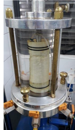
Figura 23 – Câmara cilíndrica com corpo de prova.
