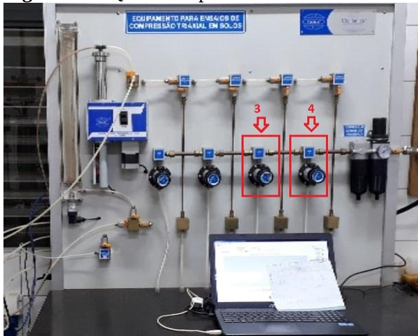
Figura 25 – Quadro de pressões.
