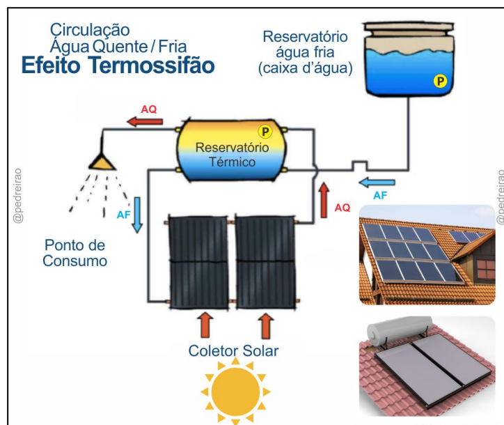
Figura 05 - Sistema de aquecimento solar
