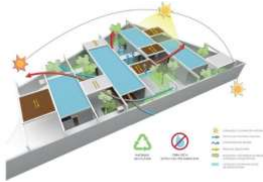
FIGURA 23 - Casa das Pérgulas Deslizantes, esquema de ventilação e iluminação natural
