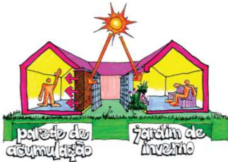
Figura 10: Aquecimento solar indireto
