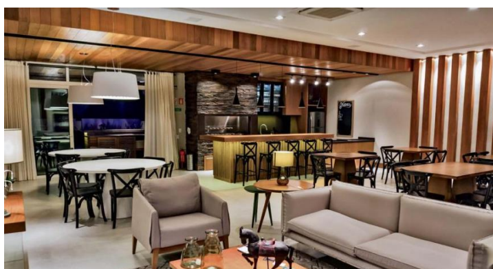
Imagem 07: Spots com LEDs em trilhos eletrificados iluminam a cozinha.
