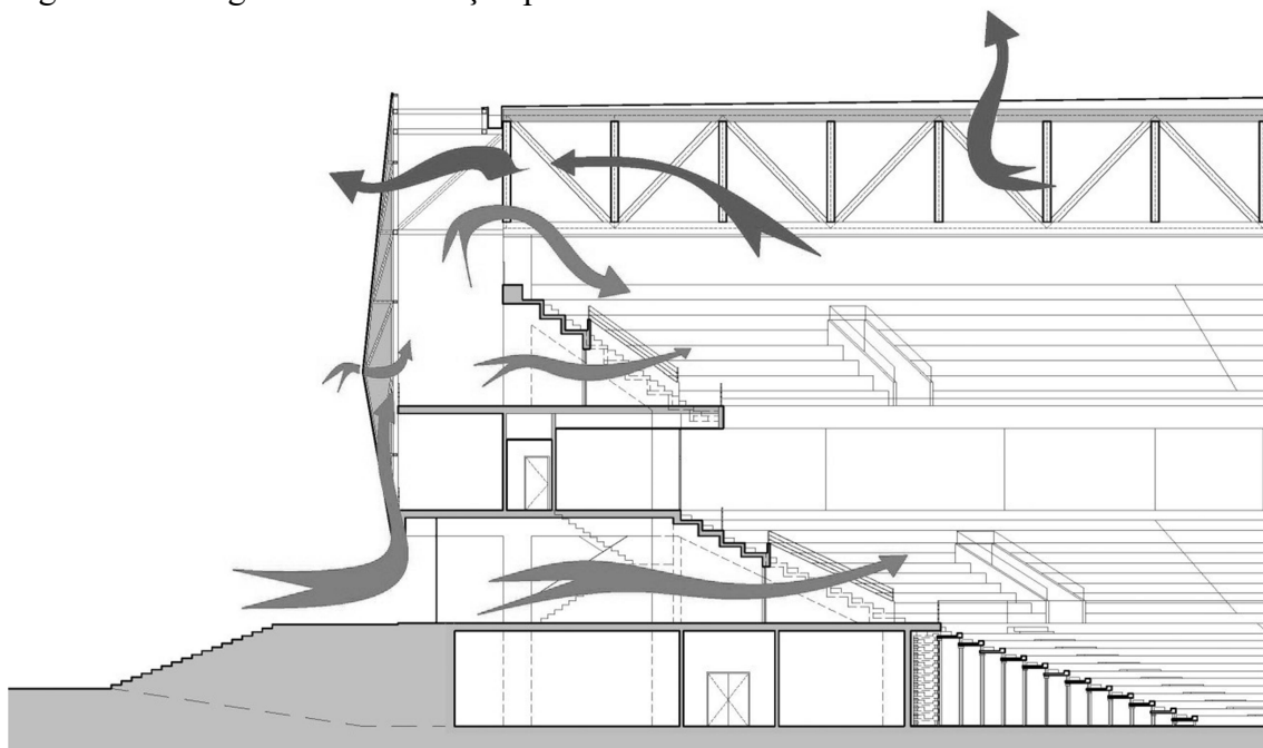
Figura 41 - Diagrama de ventilação passiva.
