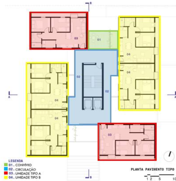
Figura 11: Planta baixa 2º pavimento com setorização.
