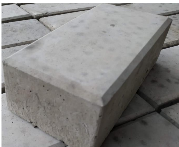
Figura 10: Modelo de pavers utilizado com dimensões 10x20x6 cm.
