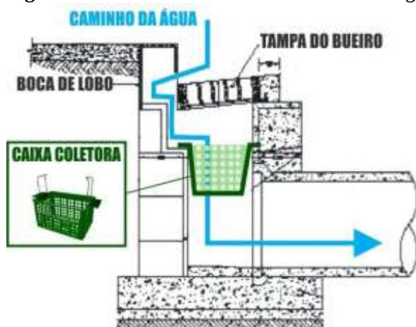
Figura 19- Caixa coletora – boca de lobo ecológica
