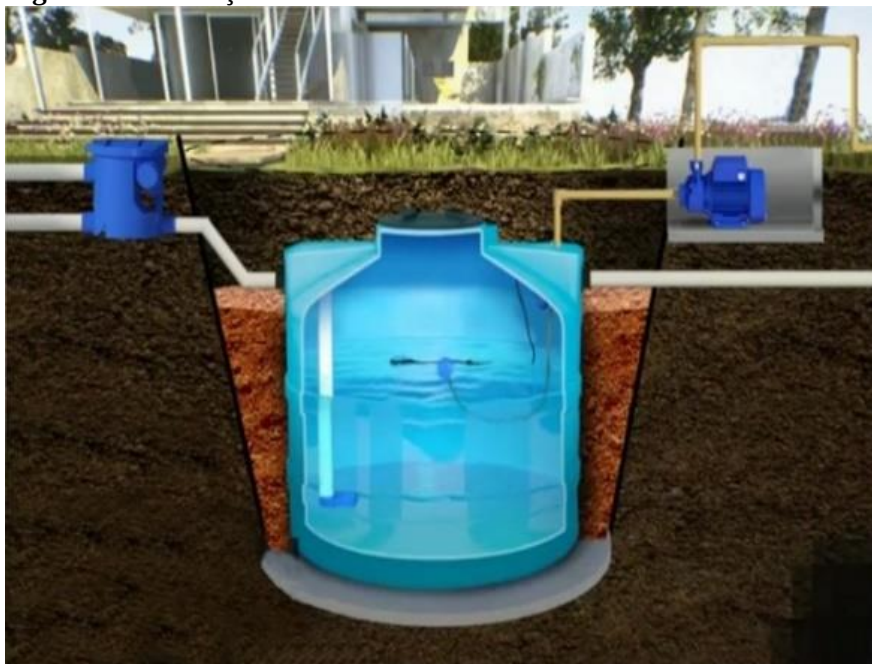
Figura 05: Instalação de reservatório enterrado.
