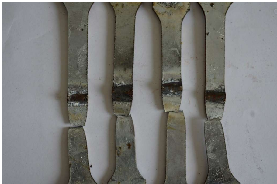
Figura 15: Corpos de prova rompidos do soldador 03.
