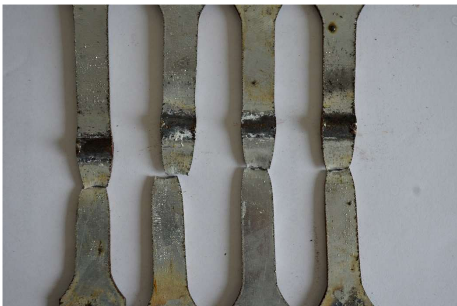
Figura 14: Corpos de prova rompidos do soldador 02.
