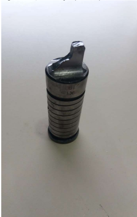
Figura 6 - Quebra do punção no aço VC131
