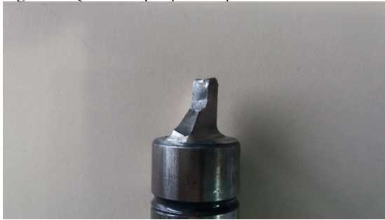
Figura 5 - Quebra do punção no aço VC131
