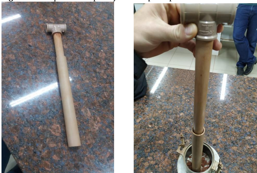
Figura 20: Soquete e compactação do corpo de prova
