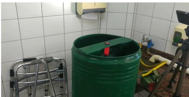
Figura 15: Corpo de prova no dispositivo em resfriamento
