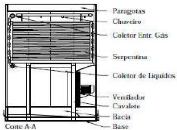
Figura 18: Condensador evaporativo
