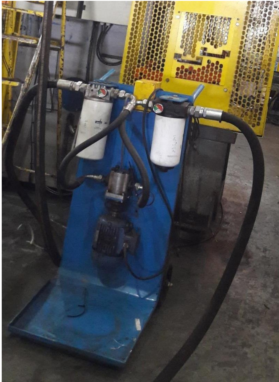
Figura 8: Filtragem do óleo Hidráulico
