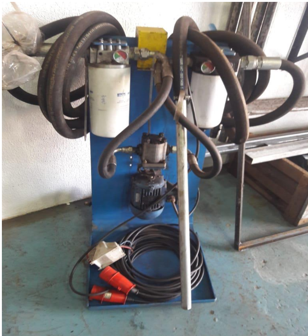
Figura 7: Sistema de filtragem de óleo móvel
