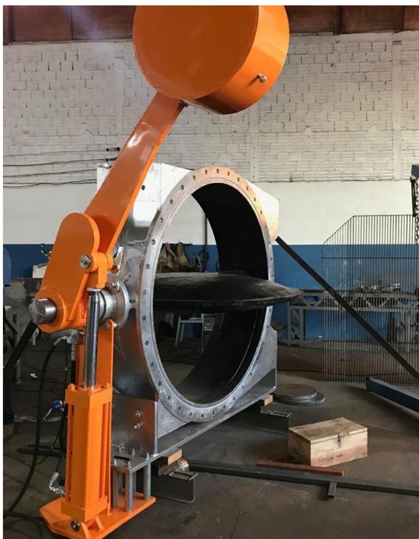
Figura 38: Válvula modernizada sendo ensaiada.
