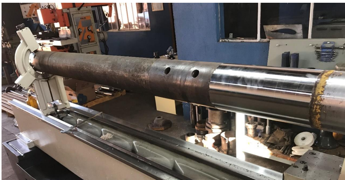
Figura 30: Eixo em processo de usinagem.
