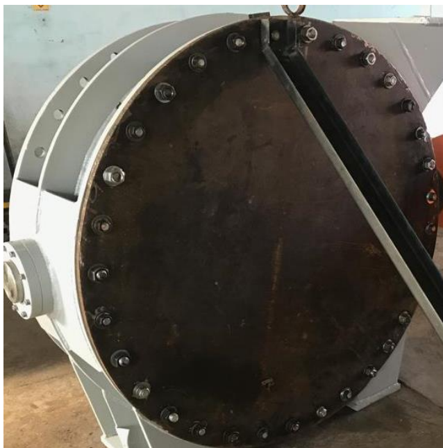
Figura 37: Dispositivo para teste de estanqueidade
