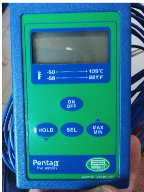
Figura 4: Termômetro Full Gauge Penta III. (Fonte: Autor)
