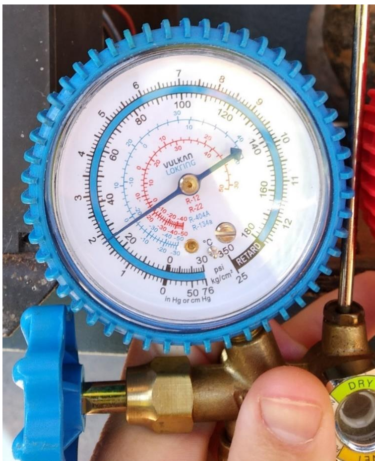
Figura 11: Medição da pressão de evaporação.
