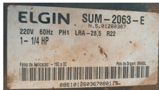
Figura 9: Etiqueta do condensador. (Fonte: Autor)
