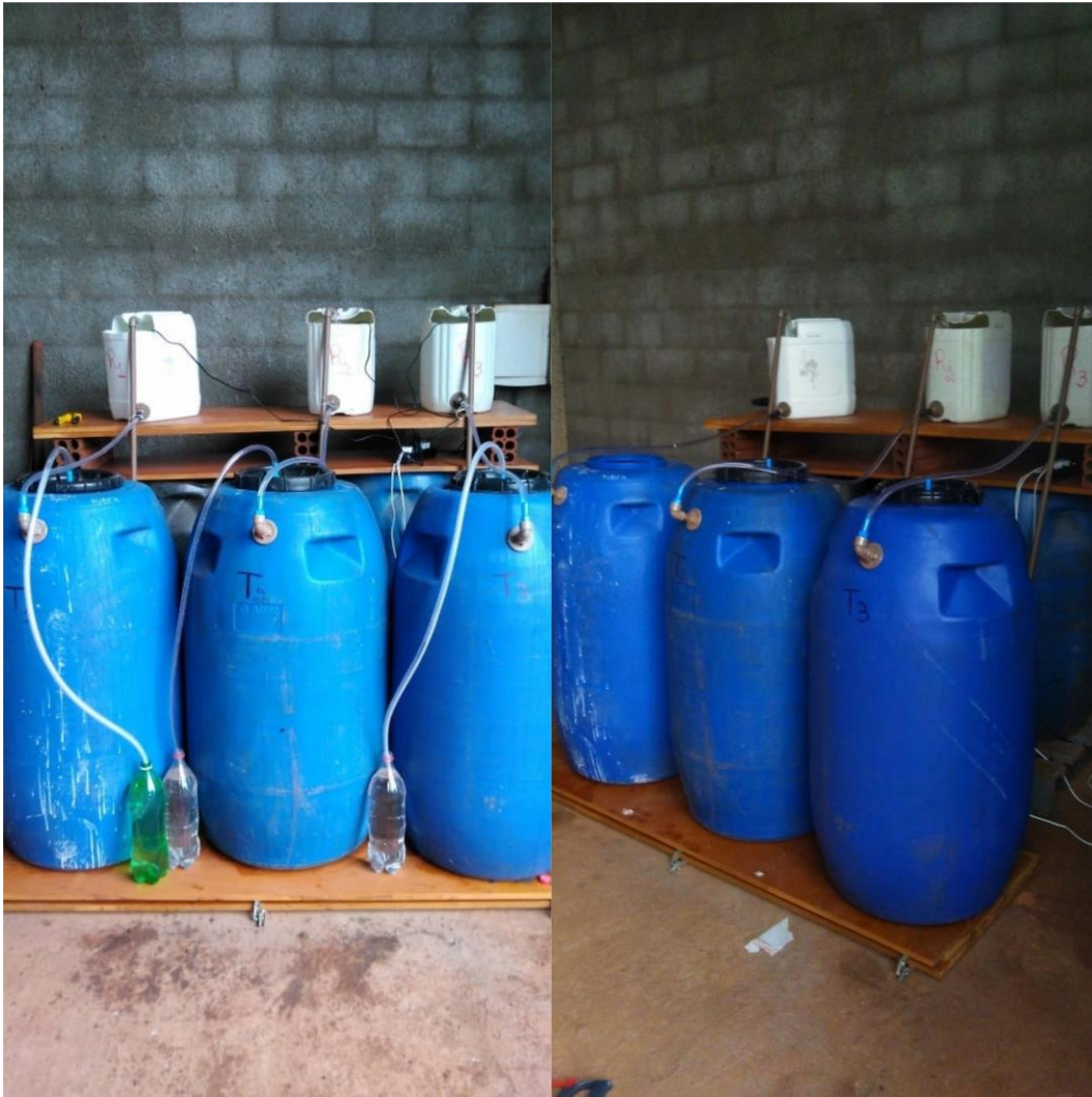
Figura 09 - Protótipo de biodigestor aquecido pela serpentina
