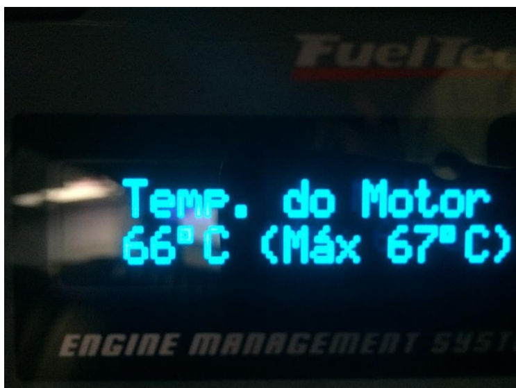
Figura 8 – Display central injeção registro temperatura 2
